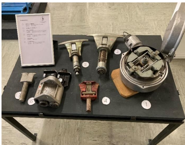
Bild 10: Entwicklung Seilklemmen und Anfahrtsbremse bei Skiliftgehänge
