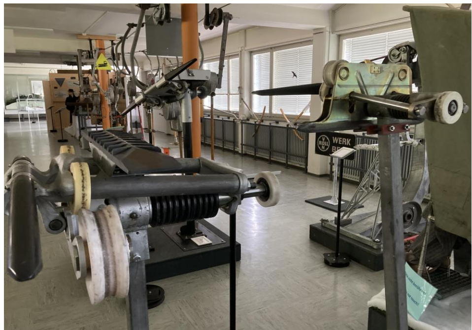
Bild 3: Kuppelbare Seilbahnklemme VH400 (links: Für Vierersessel, rechts VH400 light für 2er Sessel)
